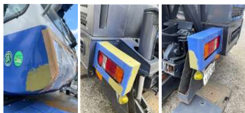
↑置き場で変形を修正し、パテ塗り
