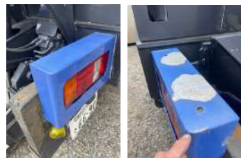
↓テールランプ周りの歪み、塗装の剥離
